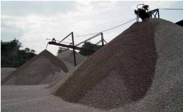
ลานกองหินโม่เหมืองตรง ยูซี ที่บดแล้ว มีการติดตั้งปืนน้ำเพื่อป้องกันฝุ่นฟุ้งกระจาย Milled rocks pile up in the Trang UC mine where water sprayers have been installed to keep the spread of dust down.
