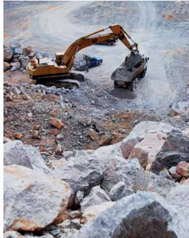
รถตักดินกำลังตักหินที่ถูกระเบิดของไว้ข้างเนินเขาในเขตสัมปทานของบริษัท ตรัง ยูซี ใส้ในรถบรรทุกเพื่อนำไปโรงบด An excavator pours rocks from the side of a hill in Trang UC concession area in a truck that will take them to the mill.
