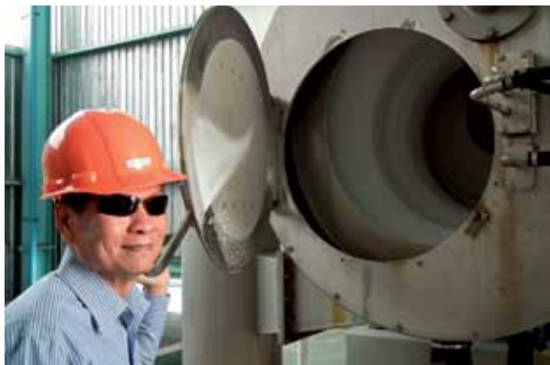
อรุณ อินชาริณศักดิ์ ผู้อำนวยการโรงงาน บริษัท เกลือ พิมาย จำกัด ยืนข้างเครื่องหมุนเหวี่ยงที่ช่วยสลัดความชื้นจากเกล็ดเกลือที่ก่อตัว
