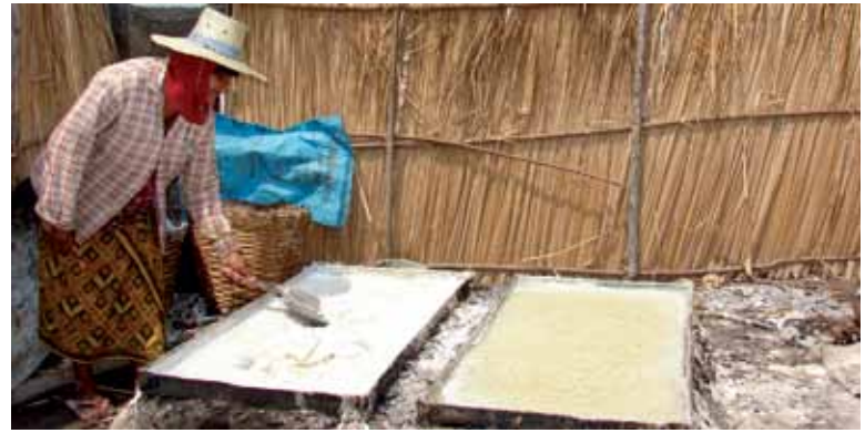
น้ำเกลือที่สูบน้ำมาจากใต้ดินจะนำมาต้มให้เกลือตกผลึก Saline water pumped up from underground well is boiled and left to dry and form salt crystals.
